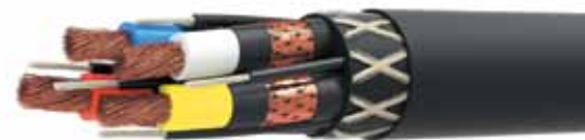
Elkamine КГТЭОС с расщепленной жилой заземления и упрочняющей оплеткой из синтетических нитей для снижения нагрузки на ТПЖ и предотвращения скручивания кабеля
