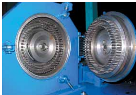
Дезинтегратор для микропомола: размер частиц 35 мкм
