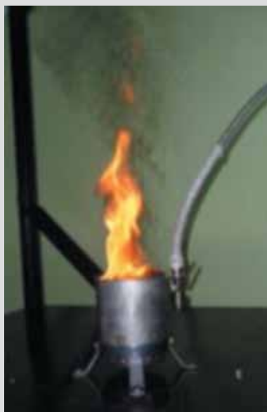
Характерный сажный режим горения дизтоплива
